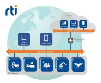
BU: Architektur der Konnektivitätsframework RTI Connext für autonome Systeme in verschiedenen Märkten (Bild: RTI)
