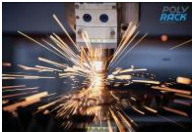
Die Auswahl der passenden Material- und Technologieverfahren, Werkzeuge und Bearbeitungsschritte sind entscheidend für eine Best-Fit-Lösung. (Im Bild: Stanzlasermaschine bei laufender Blechbearbeitung)
